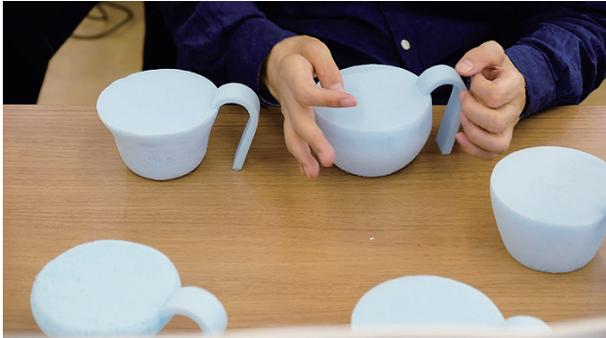
図11：製品デザイン専攻学生のスタイロフォームによる検証モデル
