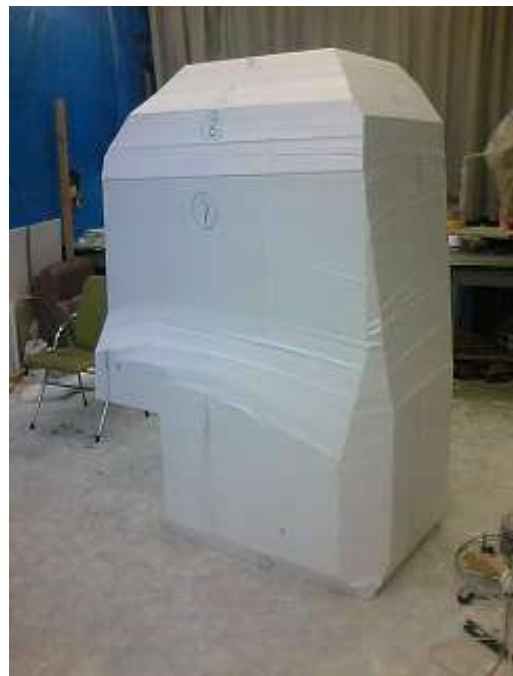
図 3-2-25: 発泡スチロールの削り出し
