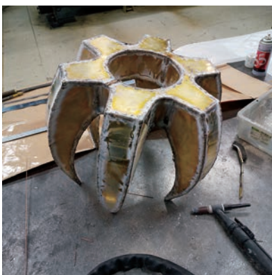
28. 全体を溶接する。
