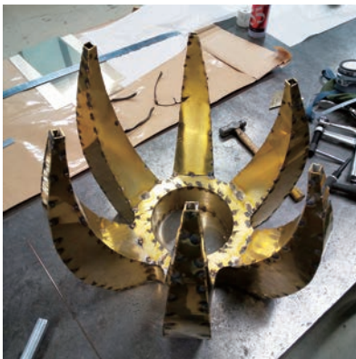
27. タック溶接（仮止め）で仕上げる。
