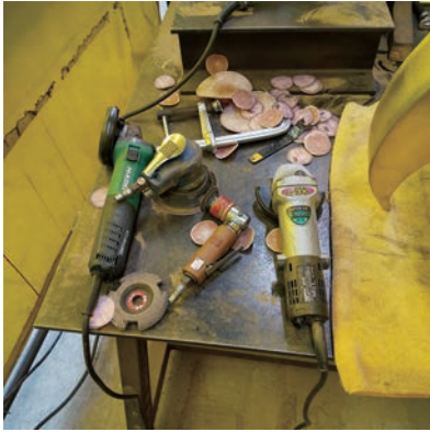
33. 2種類のグラインダーで溶接跡を削る。
