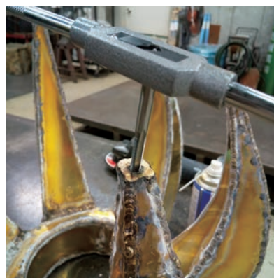
32. 溶接の熱でステンレスナットが変形するため、タップドリルでネジ山を立て直す。
