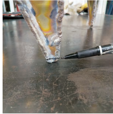
29. 接地点を合わせるため、トースカンで罫描きカットする。
