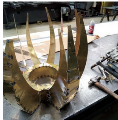
22. タック溶接（仮止め）
