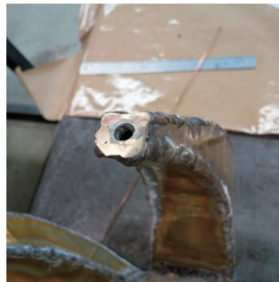
31. 6本の全ての脚に溶接後、グラインダーで削る。ステンレスナットを使用。
