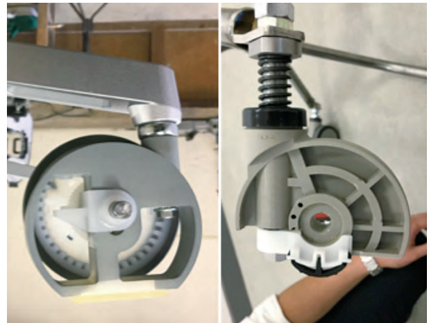
(図5) 荷重でロックが掛かる後部キャスターの機構検証試作
