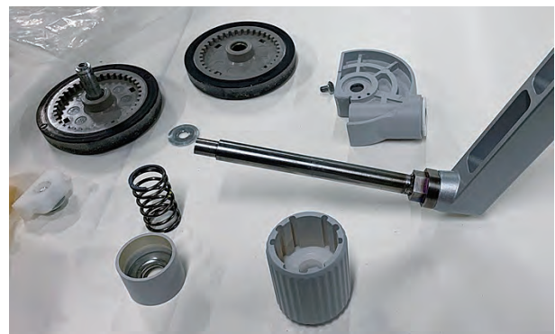
(図13) キャスターをバラしバネを交換している様子
