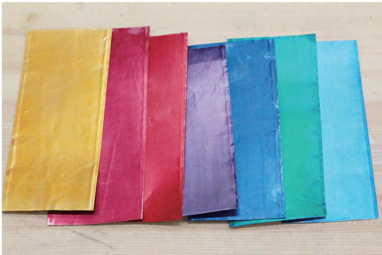
アルマイト着色を施したアルミテープ。粘着面を溶剤で剥がし紋金とする。
