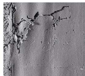
B1-S2 側光線合成写真： 虫喰いの深度が明瞭である。縦に走る撓(たわ)みがある。
