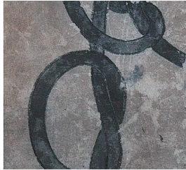
B6-UV3 紫外線蛍光写真:青灰色の紐は、紫外線が当たると暗青色に輝く。
