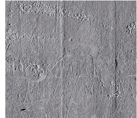
A1-S1 側光線合成写真： 本紙の棒継ぎが縦に二本走っている。上部に、本紙が横に剥けている部分がある。脚足の凸部が見える。
