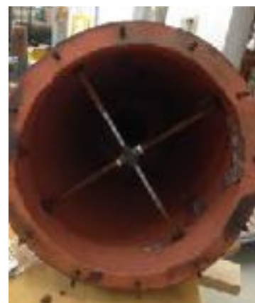
⑦長ネジを十字に取り付けた吊り下げのための構造
