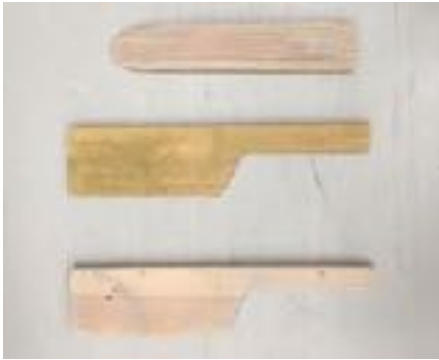
②成形に用いる板。形態によって形状の異なる板を用いる
