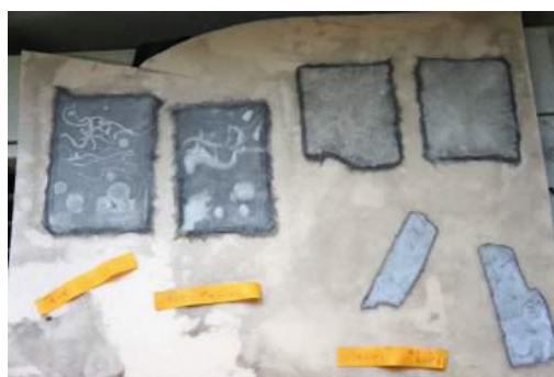
アラビアゴム溶液と白抜き剤の効果実験
