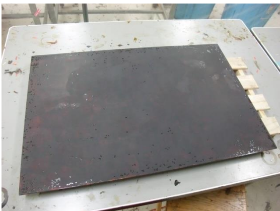
2 7 . 凹みに透箔下漆を塗る
