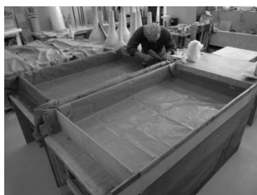
ブルーシートを被せて水槽をつくる
