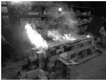
窯を密封させて還元状態にする
