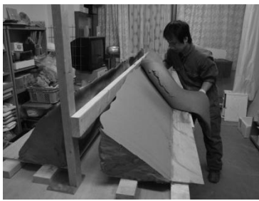
切るための枠をつくり、ワイヤで切る
