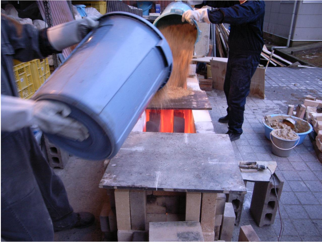
図 4-58 焼成中、もみ殻を投入する工程
