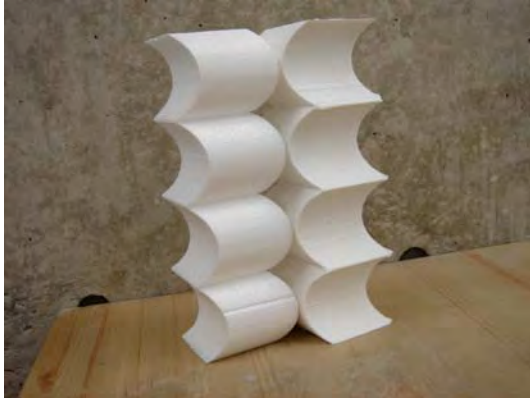
[写真1-19] 石膏原形と切り出した発泡スチロール
