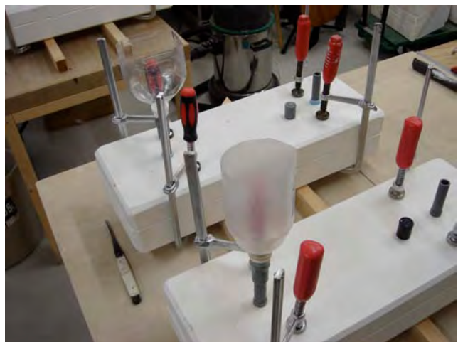
[写真2-6]石膏型の組み立て③ ペットボトル製の注ぎ口を取り付けたところ
