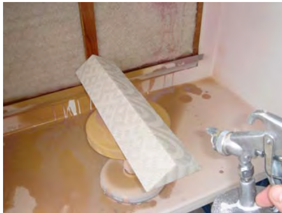
[写真2-15] スプレーガンによる吹き付け
