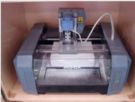
[写真1-44] 切削に用いたプロッター Roland MODELA 3D plotter「MDX-20」
