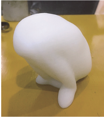
写真19 表面を仕上げたABS樹脂原形
