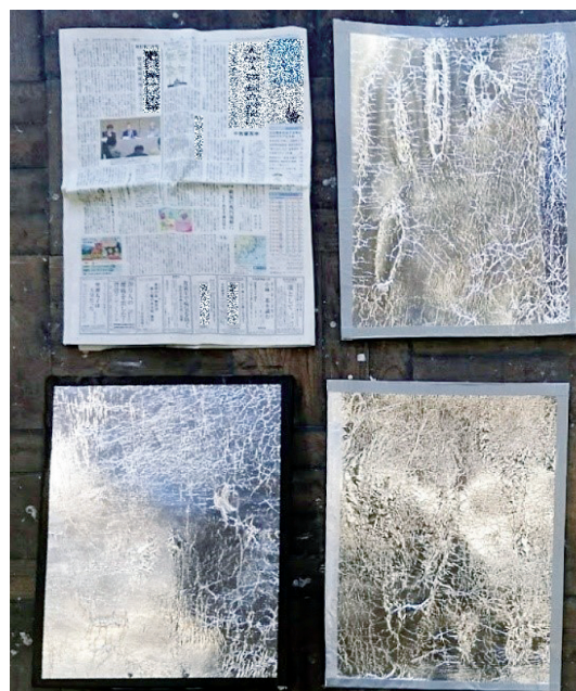
ボール紙とアルミ箔による電波反射板 （大きさの比較の為に新聞1ページを並置）
