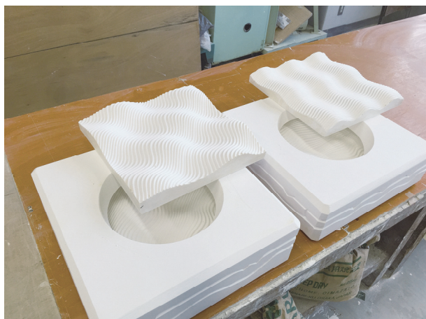
(写真5) 石膏原型と鋳込み用石膏型
