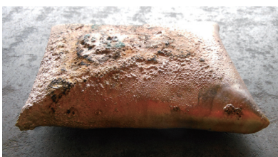
【図9】側面(厚み20mm程度) 四分一 (Cu : Ag=7.5 : 2.5)
