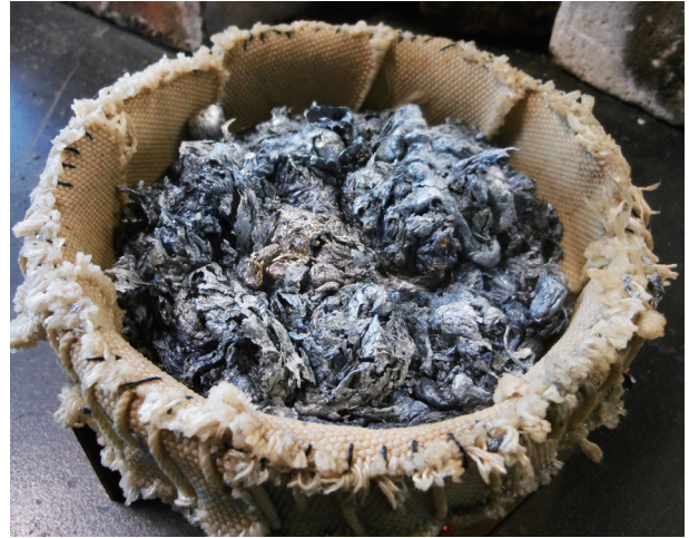
図6 湯床吹きによる銅とアルミニウムの合金
