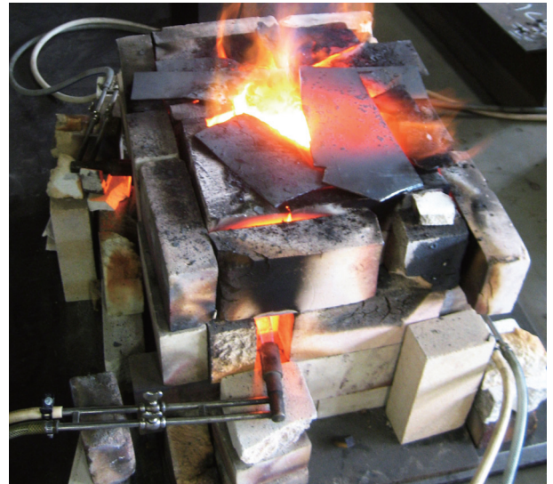
図1 耐火レンガと都市ガスバーナーを使用した溶解炉
