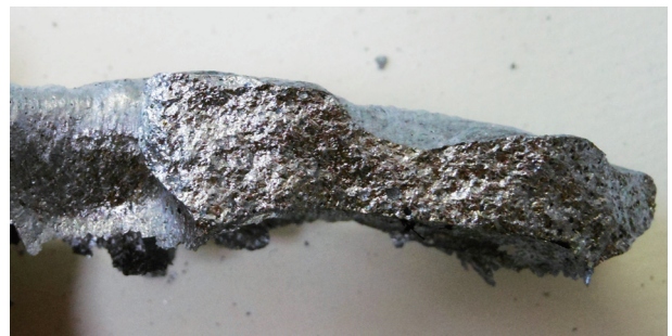
図8 湯床吹きによる銅とアルミニウムの合金 断面
