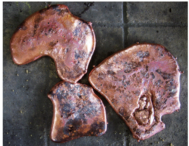
図7 湯床吹きによる純銅の地金
