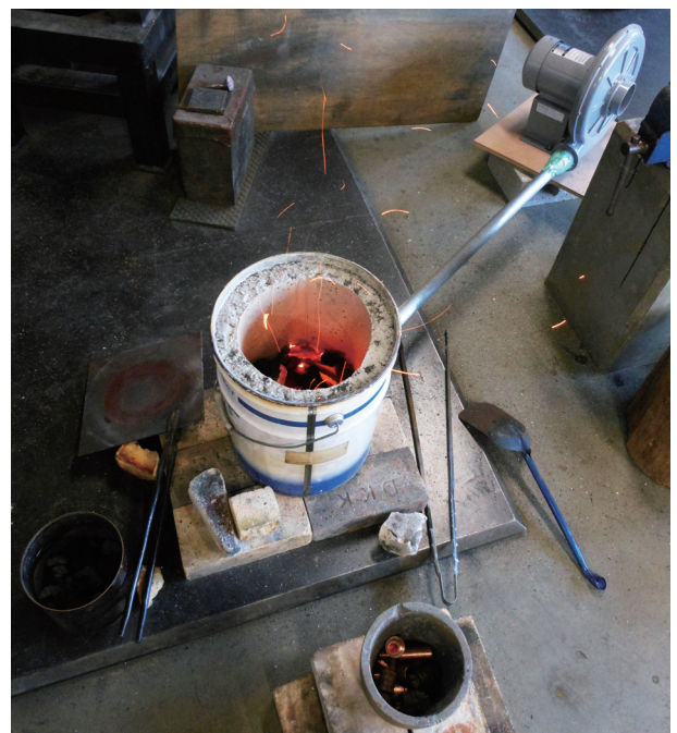
図2 耐火セメントと電動送風機を使用した溶解炉
