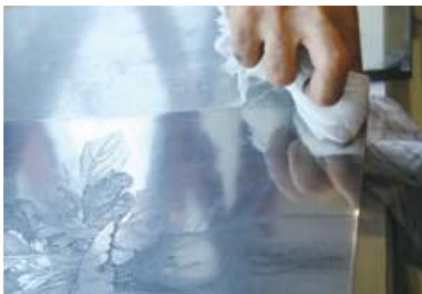
油膜の汚れなど、きれいな寒冷紗で拭き取る。
