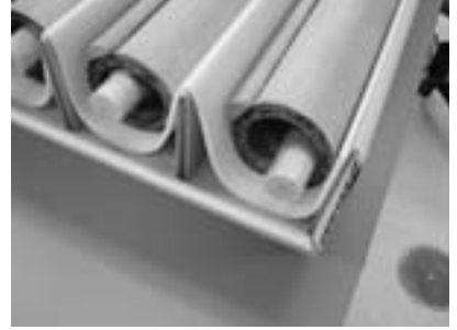
図③ プラスチックの太巻きが使用され、軸棒の周りに空間が確認できる
