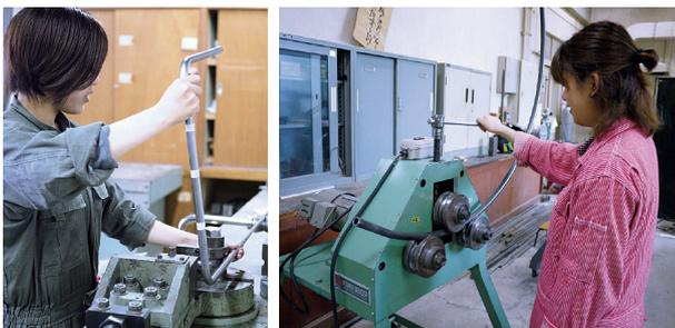
油圧ベンダーとパワーベンダーによるパイプ曲げ加工の作業風景
