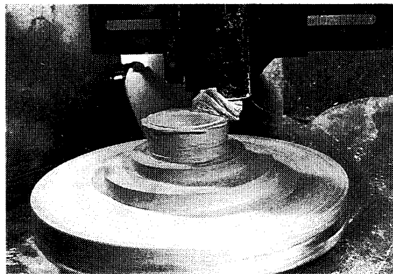
図24 昇降成形による蓋の成形
