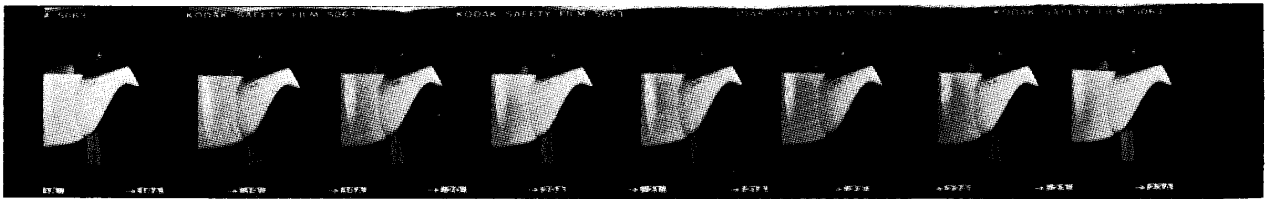
図20. No.26急須による注水実験 注水角 0^{\circ} \sim 15^{\circ} 水切り角 7^{\circ} \sim 13^{\circ}
