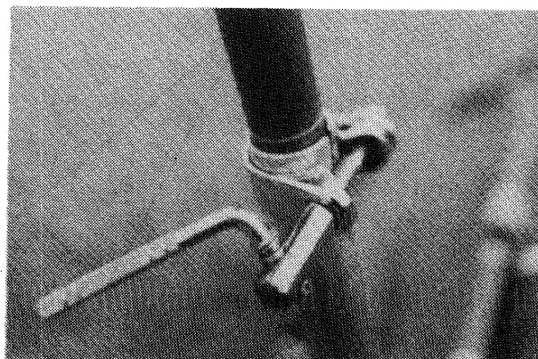
写真-6 操作棒の伸縮機構部
