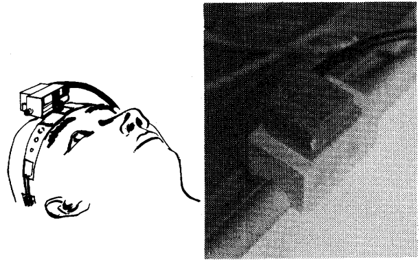
図-2 頭部に加速度計 写真-4 加速度計取り付け変換器をつける
