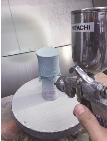
図19 スプレーガンで色泥漿を塗布
