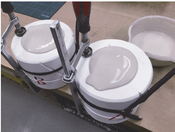
図9 泥漿を石膏型に鑄込んだところ
