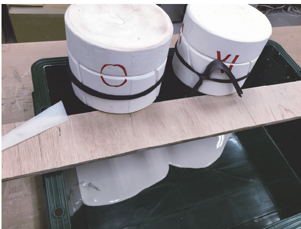
図10 排泥（余分な泥漿を流し出す）
