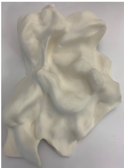
図 3-8 Sp-10 土の変形や ヒビの入り容易さの測定
