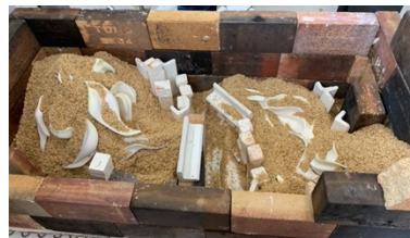
図 5-43 炭化焼成の窯詰め
