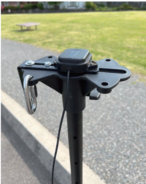
図6 計測用三脚の上に取り付けたQZSS受信アンテナ
