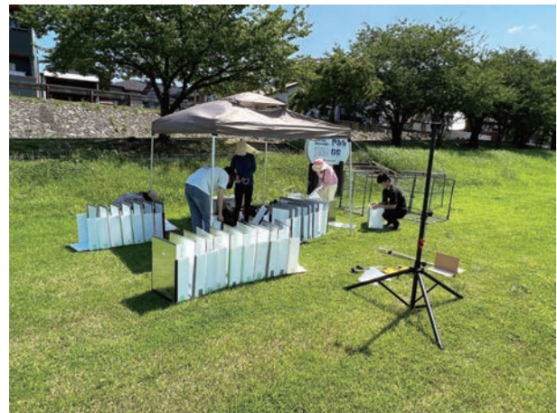
図4 QZSS受信アンテナと三脚、電波反射板
