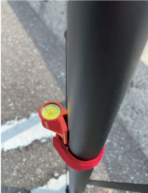
図5 QZSS受信アンテナの支柱に取り付けた水準器
