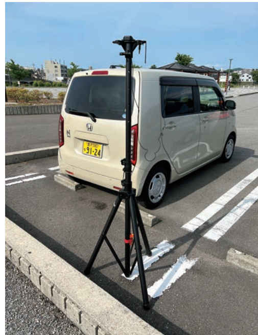
図3 QZSS受信アンテナと計測に用いた三脚（スピーカースタンドを使用）
