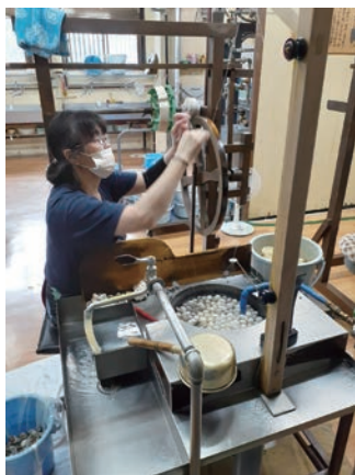
右：玉繭から糸を挽く 下：玉繭(左)と一般的な繭(右)
