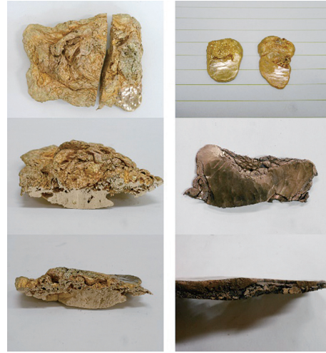
【図7】 Cu : Al=9.4 : 0.6 【図8】 Cu : Al=9.4 : 0.6 切断 打ち延ばし
