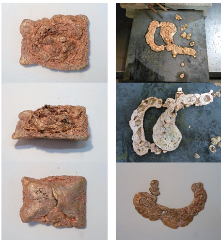
【図5】 Cu : Al=9.8 : 0.2 【図6】 鉄板上に吹いたもの
