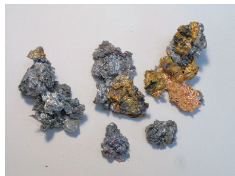
【図10】 銅アルミニウム合金の滓
