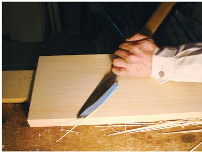
図8 槍鉋で檜板表面を削る
